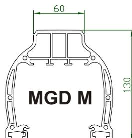
Die Toraufbauten werden normalerweise verschraubt, die Bohrrillen dafür sind funktionell und optisch verträglich angeordnet.
