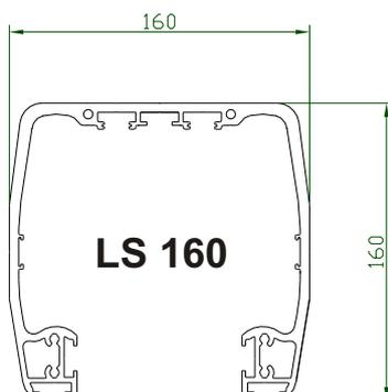
Die Laufschiene LS 160 ist für den Industrie Tor Bereich konzipiert, wird aber wegen der idealen Platzverhältnisse für den innenliegenden Antrieb auch im Privatbereich eingesetzt. Die hervorragenden Möglichkeiten zur Verschraubung an allen Seiten sowie seine Funktionskanäle machen das Profil auch ideal für den Teleskoptorbau und für Sonderanwendungen.
