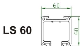
Die Laufschiene mit 60x60mm Außenabmessung wird für hängende Tore, kleinere freitragende Schiebetore sowie für Beschattungselemente und Sonderkonstruktionen eingesetzt.
